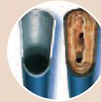
**Tuberías incrustadas y corroídas en un circuito de calefacción por efecto del agua caliente no tratada.**
