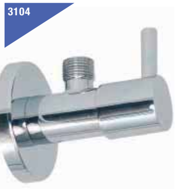
Válvula escuadra redonda "Tau" Construcción de cuerpo y florón en latón según UNE-EN 12165, cromado segun EN-248. Extremos roscados G (BSP) M-M según ISO 228/1. Apertura y cierre por montura cerámica.
