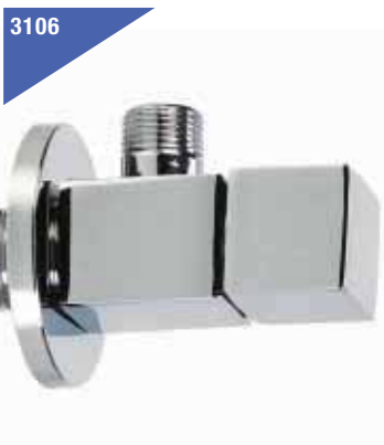
Válvula escuadra cuadrada "Cubik" Construcción de cuerpo y florón en latón según UNE-EN 12165, cromado según EN-248. Extremos roscados G (BSP) M-M según ISO 228/1. Apertura y cierre por montura cerámica.
