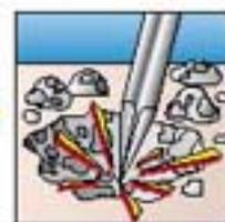
Demolición de hormigón con **SPIT 490** y puntero **SDS MAX** de 400mm de longitud.
