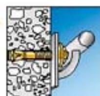
Fijación de pasamanos en hormigón con **FIX II** 8x70/20 mm. Perforación realizada con el **SPIT 329C** y brocas **R3 SDS+** Ø 8 mm.
