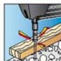
Fijación del rastrel de madera sobre hormigón con la **PULSA 700P** y los clavos **C6 40** mm.
