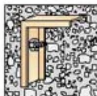
Fijación de paneles de señalización sobre hormigón con **SPIT FIX II 10x55/5**. Perforación realizada con **SPIT 320** y broca **R3 SDS+** Ø 10mm
