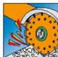
Corte para aperturas con la amoladora **SPIT AGP 230AV** y disco de diamante **TITAN** + Ø 230 mm
