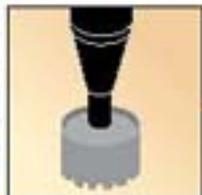
Fijación de separador de encofrado el **SPIT P370** y clavos **C9-60** premontado utilizando cargas manuales.
