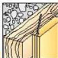
Clavado del zócalo sobre madera o placa de yeso con la clavadora de acabado **PASLODE IM65 A F16** y puntas **F16/32**
