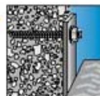
Fijación de escaleras o plataforma metálica en hormigón con **Capoña** y perno roscado **Máxima M 16 A4**. Perforación realizada con el **SPIT 362** y broca **R3 SDS Max** Ø 20
