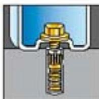
Fijación de balizas de señalización sobre asfalto con resina **SPIT EPOMAX** y fijación **SPIT ATP** M12x120. Perforación realizada con **SPIT 335** y broca triangular  $\varnothing$  18mm
