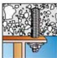
Fijación de elementos suspendidos sobre hormigón con resina **SPIT EPOMAX** y varilla **MAXIMA M12**. Perforación realizada con **SPIT 352** y broca R3 SDS MAX Ø 15mm
