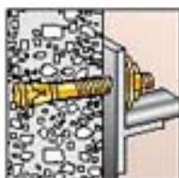
Fijación de soportes para instalaciones de comunicación con **SPIT TRIGA Z E16 24/25 A4**. Perforación realizada con **SPIT 352** y broca **R3 SDS MAX** Ø 24mm
