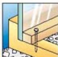
Clavado del parquet sobre rastrel de madera con la clavadora autónoma **PASLODE IM 90i** y boquilla especial parquet (clavos anillados 2,8 x 63 mm.)
