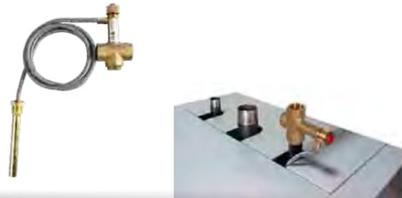
**Sistema de seguridad térmica SOLIMAX:** Kit compuesto por una pieza adaptable a la ida de la caldera con un serpentín de cobre que se introduce en el interior de la caldera y una válvula conectada al mismo kit que detecta el exceso de temperatura y abre la entrada de agua fría en caso de sobrettemperatura, para ser conducida a un desagüe (ver esquema). Hay dos modelos, uno para SOLIMAX 30 y otro para el resto de modelos.
