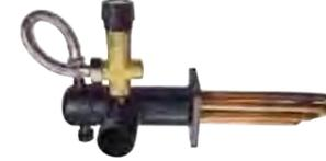
**Sistema de seguridad térmica CLX:** Kit compuesto por una T adaptable a la ida de la caldera con una válvula de dos vías y que se debe conectar al retorno de la caldera, según esquema, en caso de sobrettemperatura, el agua fría se introduce por el retorno, y el agua sobrante con exceso de temperatura se expulsa por la misma válvula, que debe ser conducida a un desagüe. Un sólo modelo para todas las potencias.
