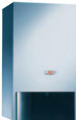
**CGB-K 40-35** Caldera mixta de condensación mural a gas. Rendimiento estacional hasta un 110 %. Estanca y modulación en aire y gas. Modulación del 20 al 100%
