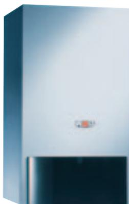
**CGB 35-50** Caldera de condensación mural a gas sólo calefacción. Rendimiento estacional hasta un 110 %. Estanca y modulación en aire y gas. Modulación del 25 al 100%
