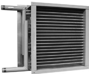
Se instala un intercambiador a dos tubos de grandes dimensiones (Tipo 4) para frío y calor. Esto tiene la ventaja de que cuando funciona en frío se dispone de suficiente potencia y cuando funciona en calor, con bajas temperaturas de calefacción o con calderas de condensación trabajando con agua a 50/40 °C y máximo volumen en recirculación se alcanzan temperaturas de salida de unos 36 °C.
